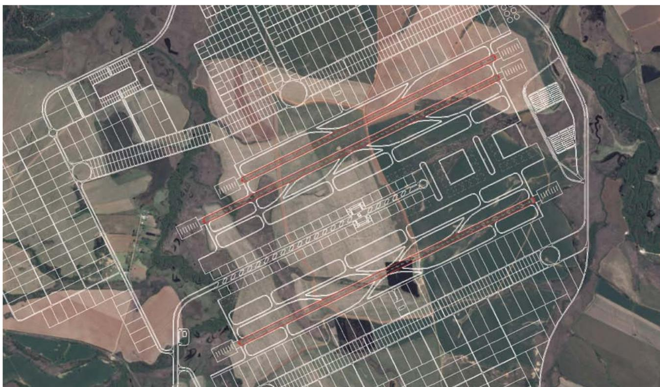
O volume de terraplenagem estimado para a área das pistas (delimitada pelas linhas vermelhas) é de 130.520.005,01m<sup>3</sup> de corte e 80.816.733,34m<sup>3</sup> de aterro. A distância entre elas foi definida a partir do eixo de projeto do Aeroporto, conforme figura abaixo.
