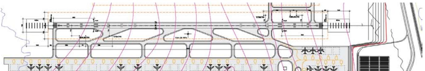
As pistas foram projetadas com os mais modernos sistemas de segurança, luzes aeronáuticas de superfície, sinalizações horizontais, sinalizações verticais e painéis, auxílios à navegação aérea, destacando-se a instalação do sistema de pouso por instrumento ILS categoria III.
